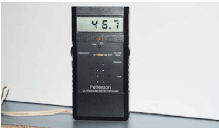
Slika 1. Bat-detektor marke Pettersson D240. Trenutačno je u heterodyne načinu rada, a namještena frekvencija na zaslonu odgovara onoj patuljastog šišmiša ( P. pipistrellus ).
