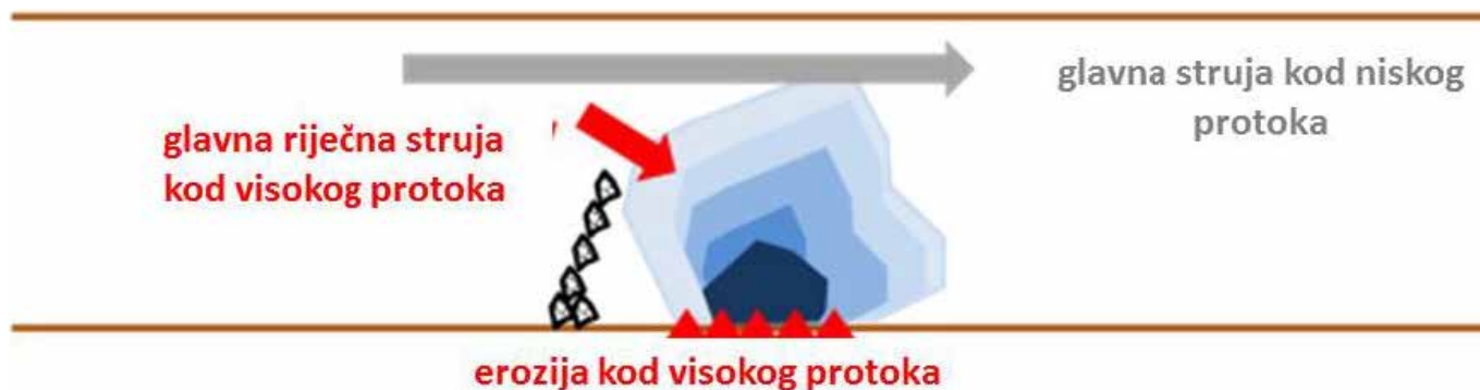
Slika 18: Deklinirajuća pera pri niskom protoku usmjeravaju struju prema sredini rijeke, dok pri visokom protoku struja uzrokuje eroziju riječne obale. Autorska prava: Guttman- također vidjeti (Eberstaller-Fleischanderl i Eberstaller, 2014)
