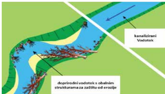
Slika 24: Stabla korištena za zaštitu vanjskog zavoja (učvršćena čeličnim kablovima). (Autorska prava: Eberstaller Zauner Buros (2015))
