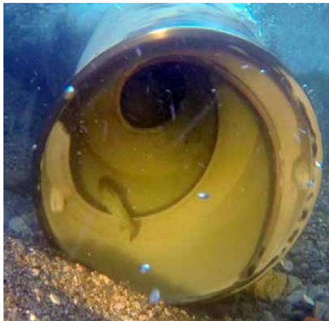
Slika 16: Detalj izlaza i ulaza u Arhimedovu hidrodinamičku pužnu turbinu; Fotografija: Hydroconnect
