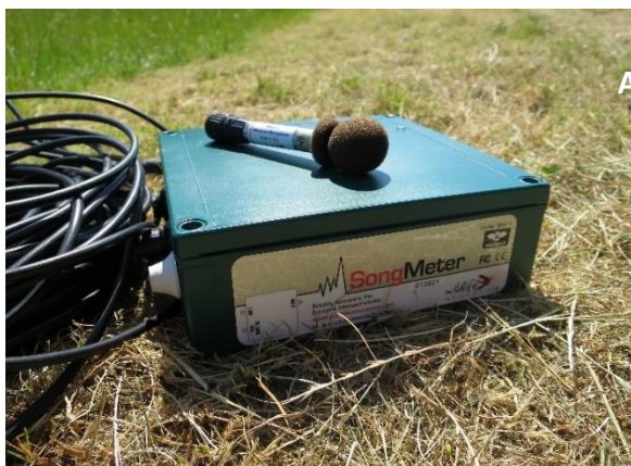
Slika 3-3 Praćenje šišmiša na točkastim lokalitetima: A – SM2BAT+ stacionarni automatski ultrazvučni detektor, B – Postavljanje detektora, C – Mikrofon detektora postavljen iznad vegetacije na točki praćenja (Foto: D. Rnjak)
