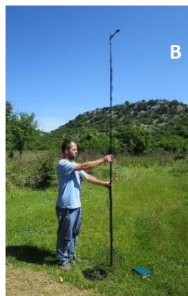
Slika 3-3 Praćenje šišmiša na točkastim lokalitetima: A – SM2BAT+ stacionarni automatski ultrazvučni detektor, B – Postavljanje detektora, C – Mikrofon detektora postavljen iznad vegetacije na točki praćenja (Foto: D. Rnjak)
