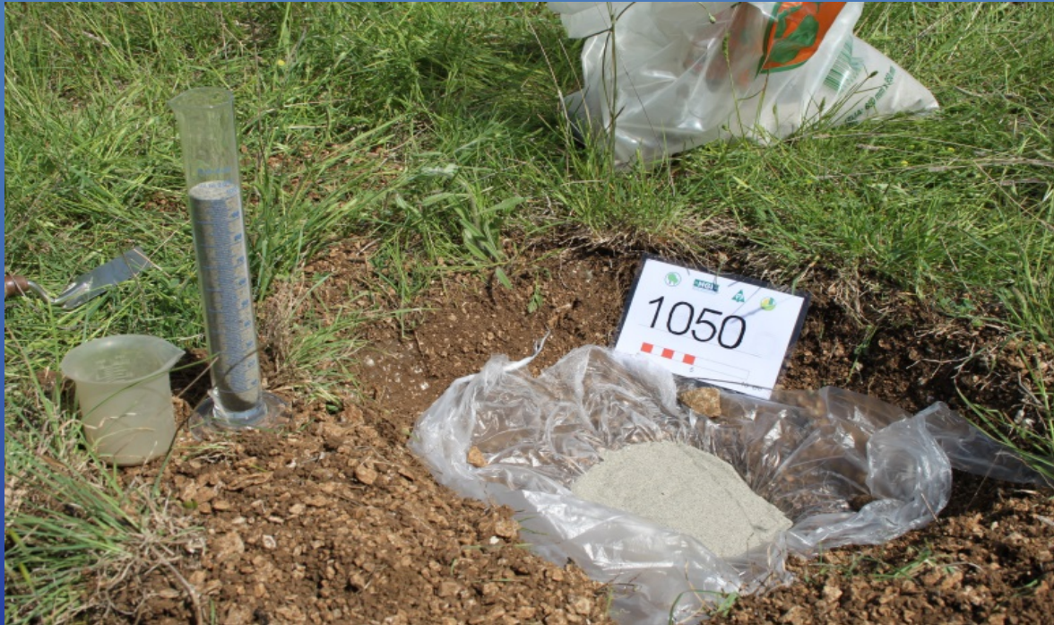
Slika 3. Uzorkovanje prema normi HRN ISO 11272 (sa pijeskom) u kamenitom tlu radi utvrđivanja volumne gustoće .
